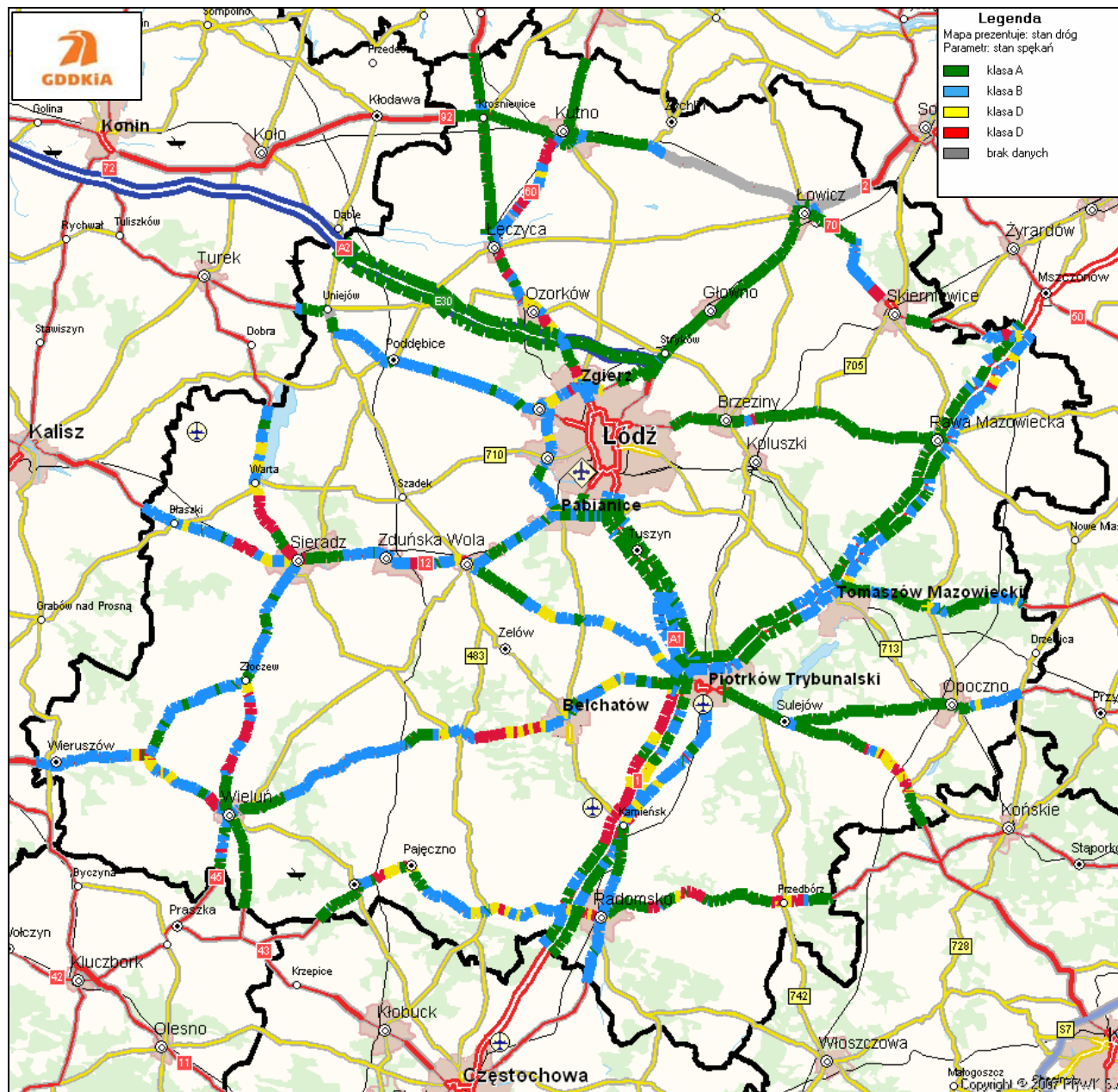
Rysunek 40. Lokalizacja odcinków ze stanem spekań w różnych klasach technicznych na terenie Oddziału w Łodzi
