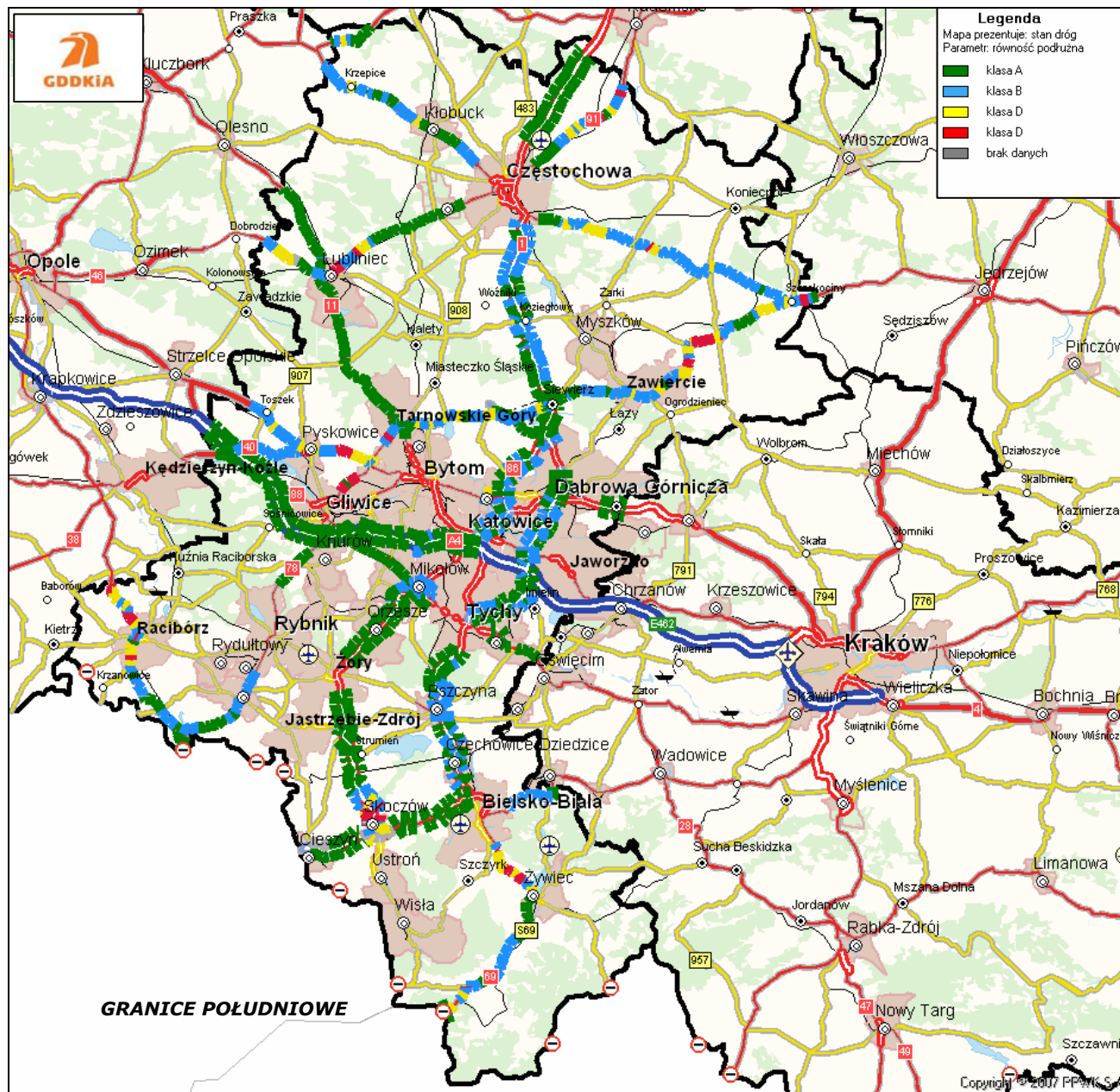
Rysunek 20. Lokalizacja odcinków z równością podłużną w różnych klasach technicznych na terenie Oddziału w Katowicach
