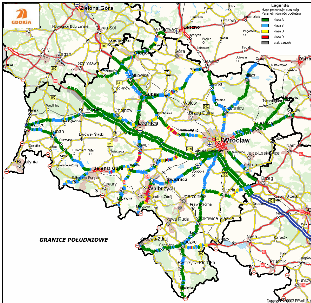
Rysunek 31. Lokalizacja odcinków z równością podłużną w różnych klasach technicznych na terenie Oddziału we Wrocławiu
