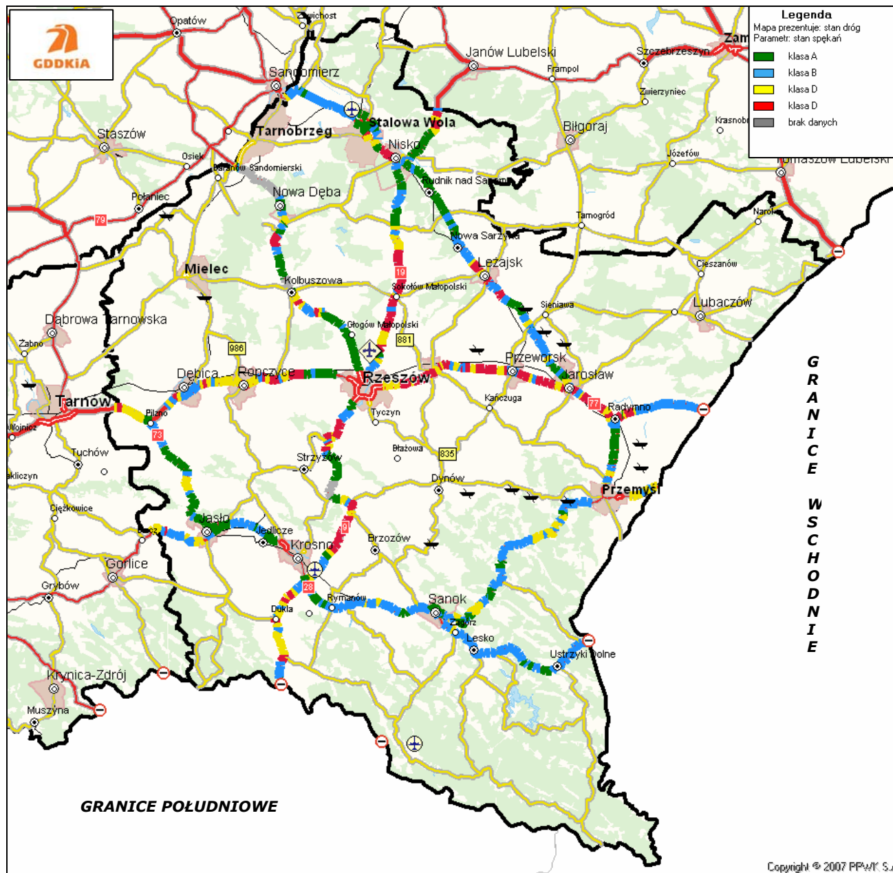
Rysunek 44. Lokalizacja odcinków ze stanem spekań w różnych klasach technicznych na terenie Oddziału w Rzeszowie
